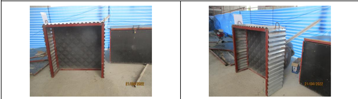
รูปที่ 20 ที่ครอบเสียงแบบเคลื่อนย้ายได้
